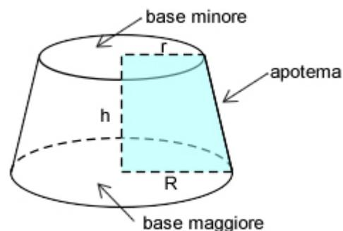
Il tronco di cono circolare retto può essere pensato come il risultato della *rotazione completa di un trapezio rettangolo attorno al lato perpendicolare alle basi*.
