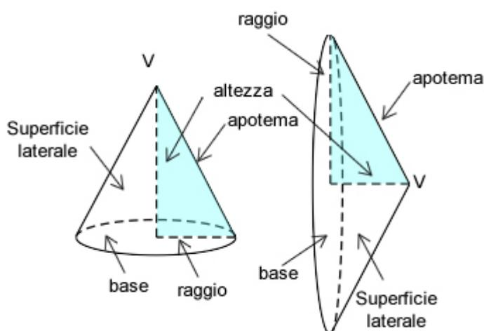
Il **cono finito circolare retto** è il solido che si ottiene ruotando di  $360^\circ$  un triangolo rettangolo attorno ad un'asse che passa per uno dei cateti.
